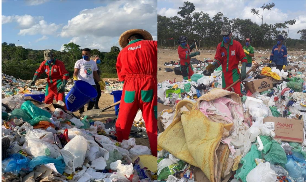
Figura 14 - Espalhamento e homogeneização das amostras de resíduos sólidos.
